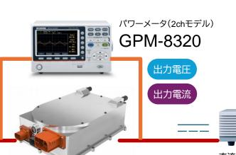
直流電子負荷装置 DUT:AC/DCコンバ-LSG-A Series
