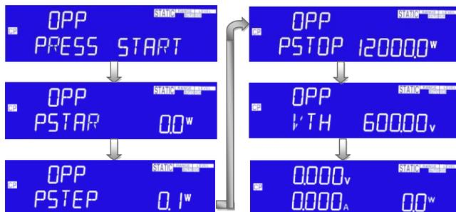
PSTAR: 開始電力を設定します。LCD 内の左側 5 桁のディスプレイに「OPP」、中央 5 桁のディスプレイに「PSTAR」、右側 5 桁のディスプレイに設定値が表示され、単位は「W」です。設定範囲は 0.00W から CP モード仕様のフルスケールです。ロータリノブを回して設定します。
