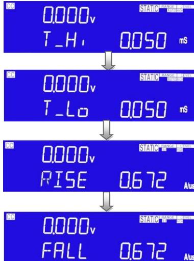
DYN Setting キーを押すと、LED が ON し High レベルの時間設定になり、LCD 内の中央 5 桁のディスプレイに「T\_Hi」が表示され、右側 5 桁のディスプレイに設定値が表示されます、単位は「ms」です。T\_Hi の設定範囲は 0.010ms~9999ms で、0.001ms ステップです。ロータリノブを回して設定します。
