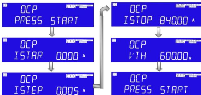
ISTAR: 開始電流ポイントを設定すると、左側 5 桁のディスプレイには「OCP」が表示され、中央 5 桁のディスプレイには「ISTAR」が表示され、右側のディスプレイには設定値が表示されます。単位は「A」です。設定範囲は、0.001A から CC モード仕様のフルスケールまでです。ロータリノブを回して設定します。
