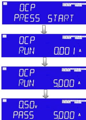
8. DUT の出力電圧降下がしきい値電圧 (V-th 設定) より低く、OCPトリップポイントが I<sub>Hi</sub> と I<sub>Lo</sub> リミット間にある場合、中央の 5 桁の LCD ディスプレイに「PASS」と表示され、それ以外の場合は「FAIL」と表示されます。
