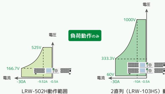
※上記は双方向直流電源 (PBW) と電流極性を合わせた動作範囲を示していますが、実際の操作・表示は正極方向に表示されます。
