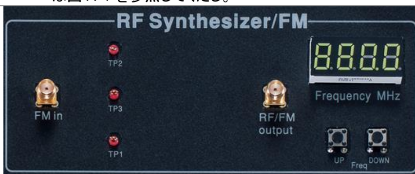
図 A-5. RF シンセサイザ/ FM モジュール
