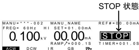
2. 再度、停止(STOP)ボタンを押すと、READY(準備完了)を表示します。
