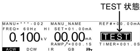
6. 試験が実行すると上昇(RAMP UP)時間の残時間を表示します。そして、自動的に試験に進み、試験の残時間を表示します。単独試験は、設定された時間または、停止されるまで、試験を継続します。
